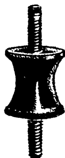
7440 (8524312) Soporte caño de escape modelo 4 L Ø 21 mm. h 19 mm. rosca M 6 x 1
