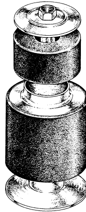
3418 (D5UZ1000155A) Soporte trasero de cabina modelo F 100 año 1981 en adelante
